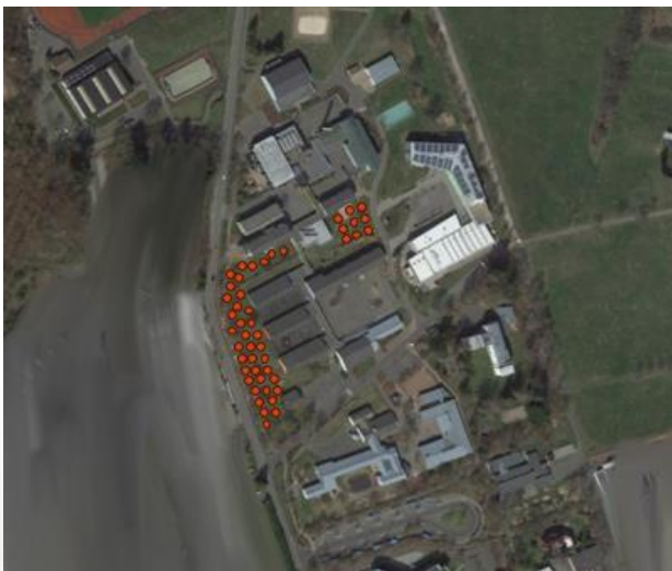
Abbildung 25: Mögliche Positionierungen der 47 Sonden für die Sole/ Wasser-Wärmepumpe zwischen den Gebäuden der Marie-Curie-Realschule Plus und der Kirburger Straße (Google Maps, 06/2023, Eigene Bearbeitung)
